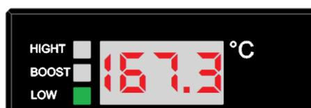
Per settare la temperatura in piastra in modalità HIGHT (temperatura in piastra 200°C) ruotare verso sinistra il selettore posto sotto il display per 3" e rilasciarlo. Luce led arancione accesa.
